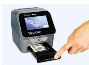
抽出液 100 μL をドン-Vストリップテストの円形開口部に垂直に入れる、流出量が 1 滴/秒になるように操作し、ストリップテストが現像するのを 5 分間待ち、インキュベーター (40° C) 内に残します。
