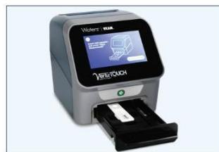
ストリップテストを “バートゥタッチ (VERTU TOUCH) リーダー” に円形開口部から挿入し、次に [Start Measurement] ([測定開始]) を押します。
