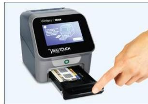
ストリップテストを「バートタッチ (VERTU TOUCH) リーダー」に円形開口部から挿入し、次に [Start Measurement] ([測定開始]) を押します。
