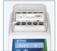
抽出液 100 μL をドン-Vストリップテストの円形開口部に垂直に入れ、流出量が 1 滴/秒になるように操作し、ストリップテストが現像するのを 5 分間待ち、インキュベーター (40° C) 内に残します。
